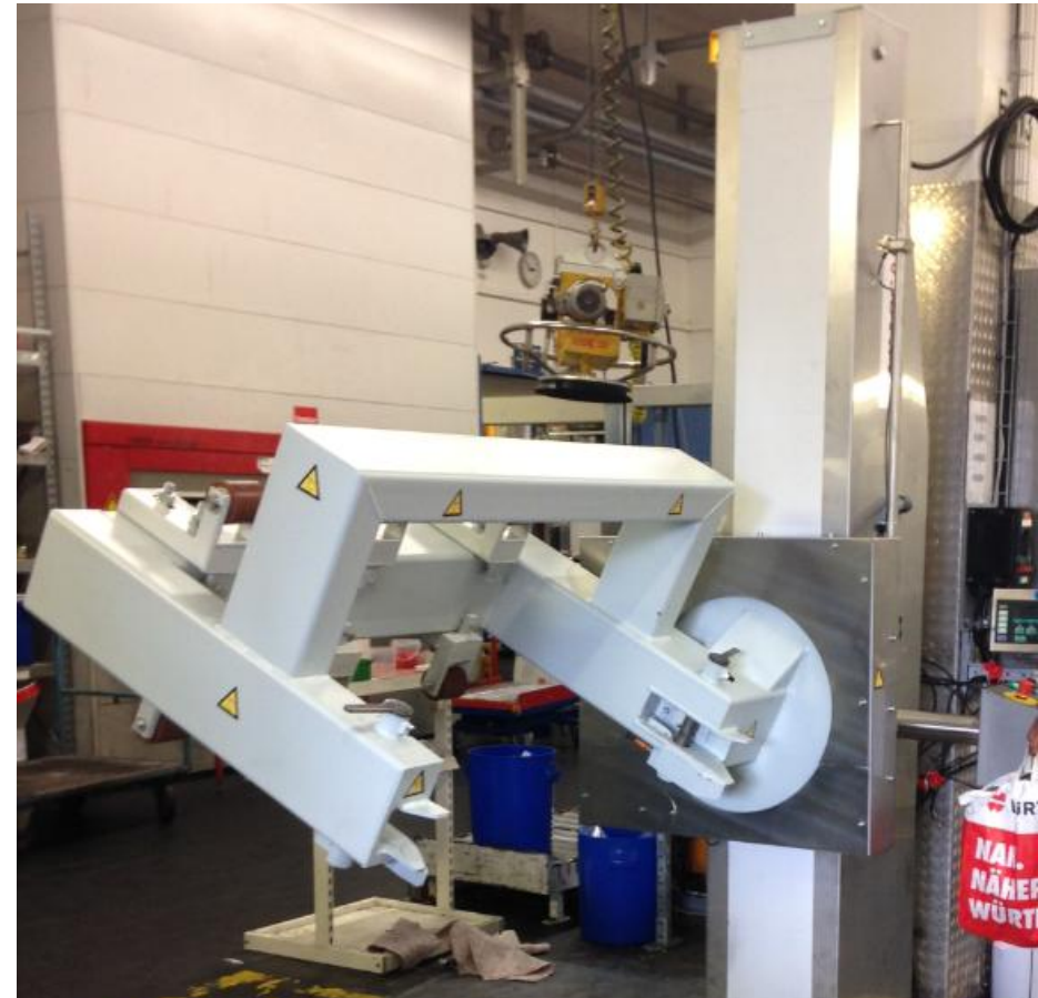
„ Beispiel eine Container-Hubsäule “ Einsatz im Chemie Industrie
